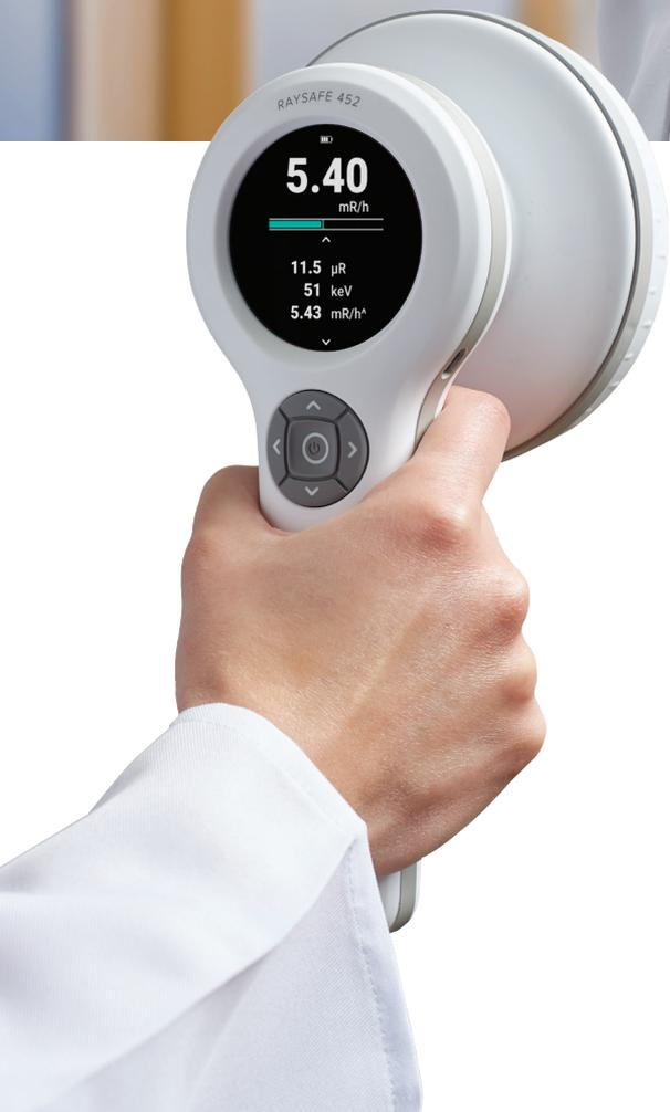
El RaySafe 452 es un monitor que mide la radiación ionizante en una amplia variedad de aplicaciones, como la búsqueda de isótopos derramados, la medición de la radiación dispersa de las máquinas de rayos X y los aceleradores lineales.
